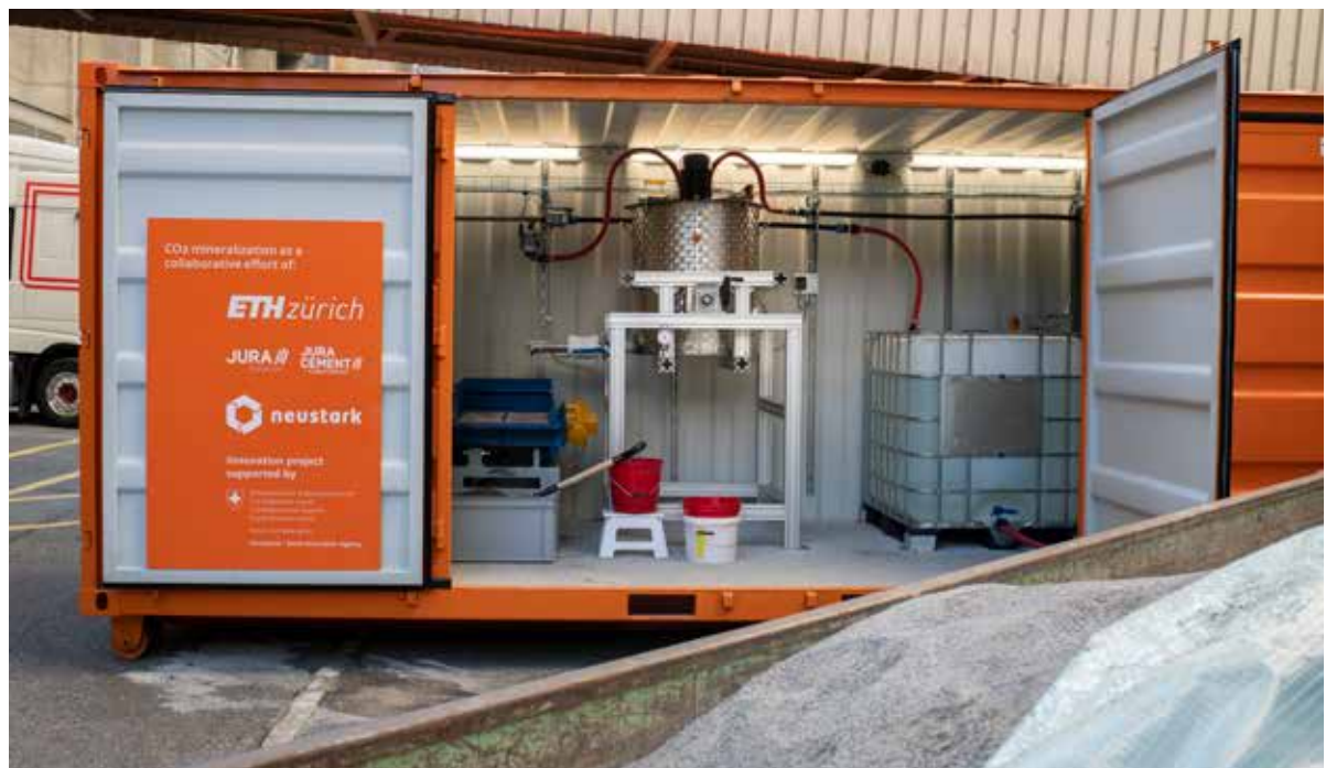
▲ Pilotanlage für indirekte Carbonisierung von Materialien (©neustark ag)
